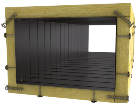
Obr. 71 Horní deska překrývá boční desky, které překrývají spodní desku
