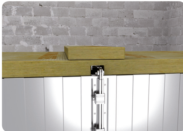
Obr. 47 Je-li použita izolační deska o tloušťce ≤ 40 mm, nad přírubu se umístí pásek druhé vrstvy izolace o min. tloušťce 30 mm a šířce 150 mm
