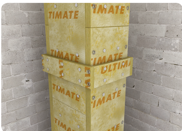
Obr. 48 Rozmístění trnů a vrutů Fire Screw u přidavné druhé vrstvy izolace
