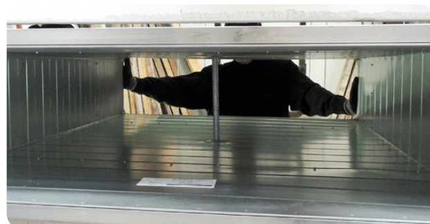
Obr. 66 Vyztužení segmentu potrubí uprostřed rozpětí
