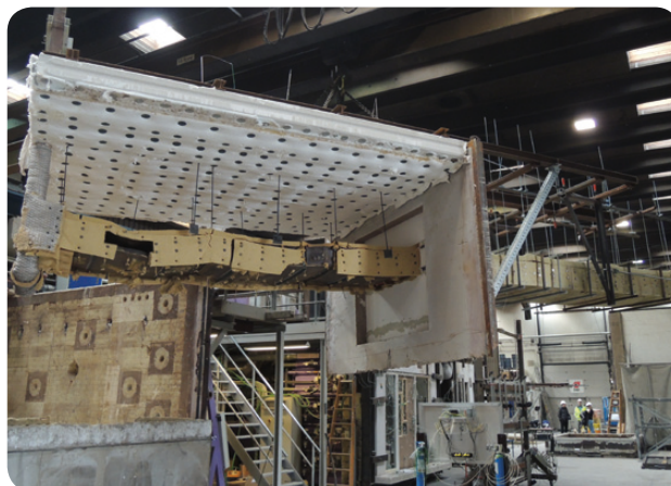
Obr. 17 Pohled na potrubí typu C po 120 minutách působení normového požáru
