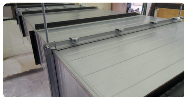
Obr. 67 Vnější vyztužení L-profilů
