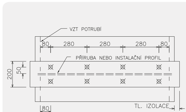
Obr. 28 Detail kotvení druhé vrstvy izolace, není-li zachováno krytí izolace nad přírubou nebo instalačním profilem min. tloušťky 20 mm
